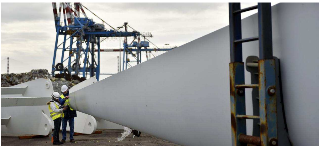
Deux ouvriers inspectent, à l'aide d'un appareil à ultrasons, la pale d'une éolienne offshore sur le chantier de Saint-Nazaire, mardi.
